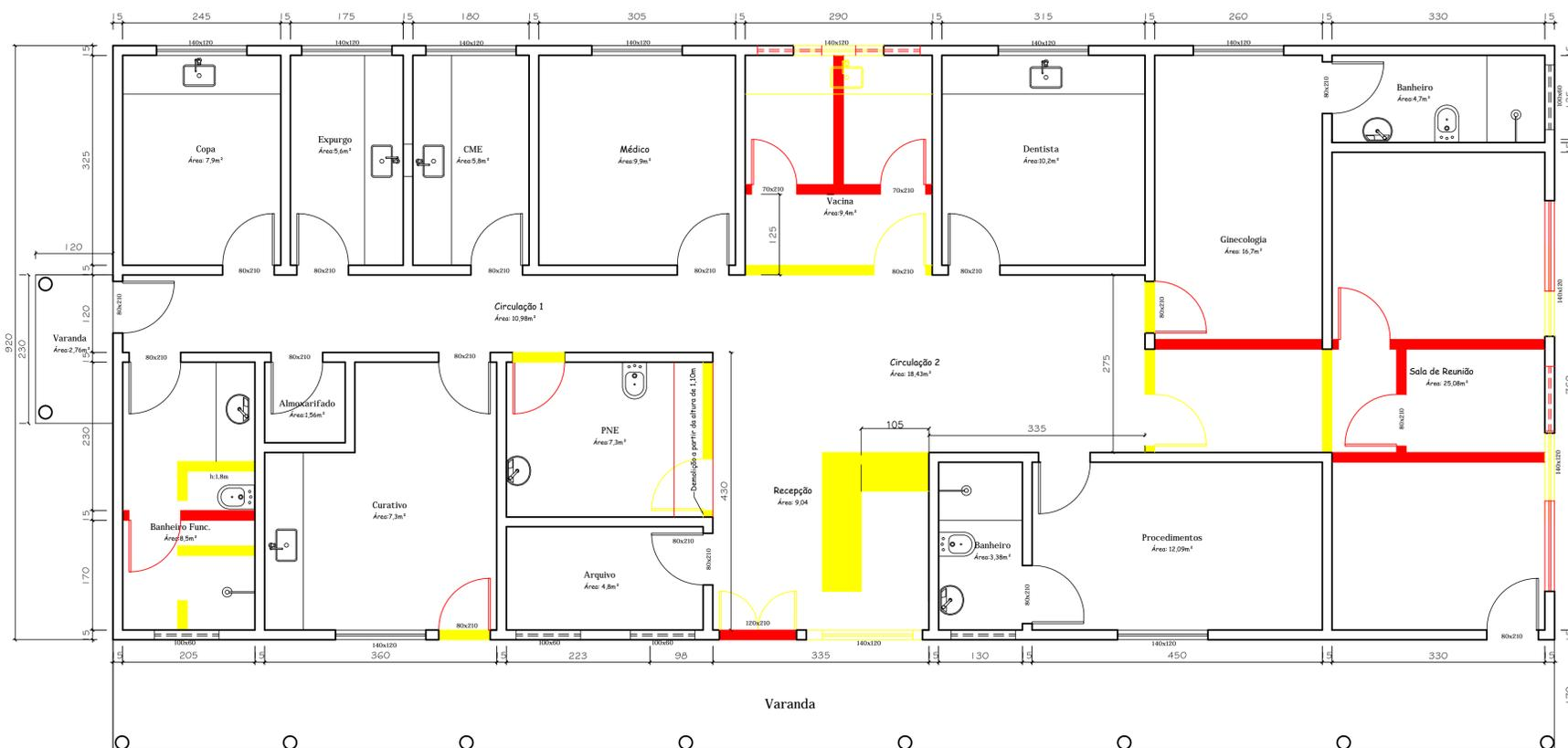
**2** Planta - Demolição/ Construção
